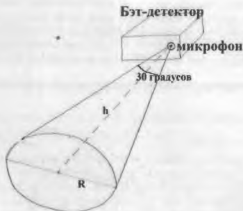
Рис. 2. Схема, поясняющая процесс фиксации пролета летучей мыши бэт-детектором
